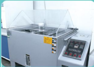
盐雾试验机 Salt spray test machine
