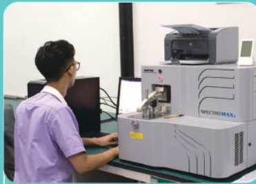
斯派克光谱分析仪 Spike spectrum analyzer
