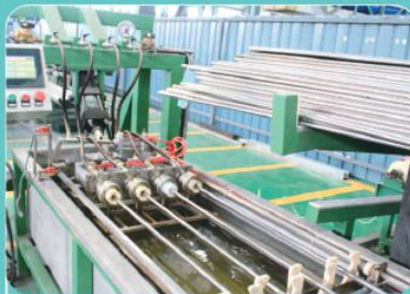
气密测试 Air tight test
